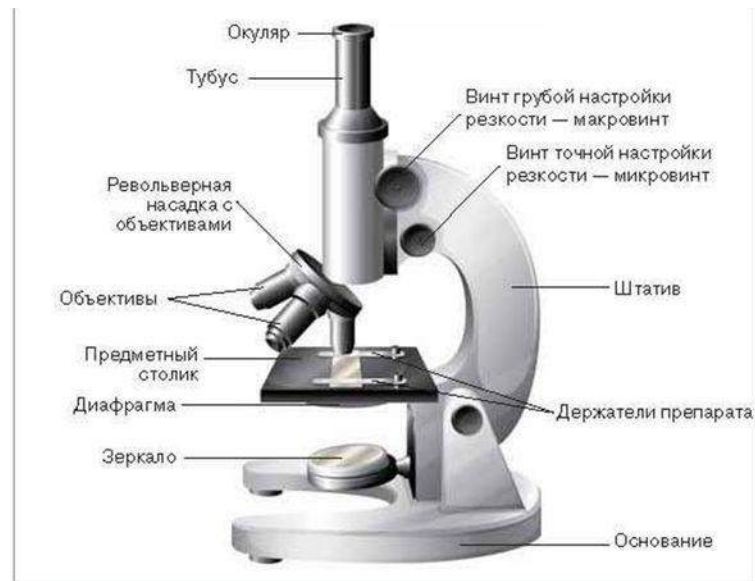
Рис. 6. Внешний вид и основные составляющие школьного микроскопа
